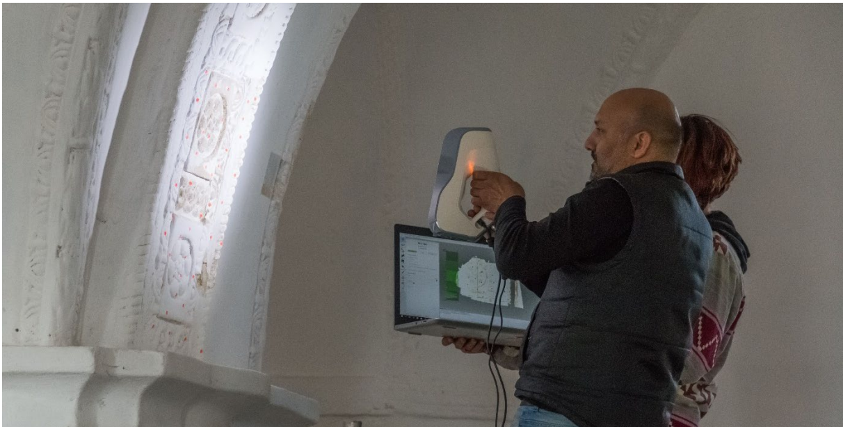
Obr. 29 Skenování štukové výzdoby v kostele sv. Michala v Poličce přenosným skenerem Artec Eva, foto: Vojtěch Krajíček.
