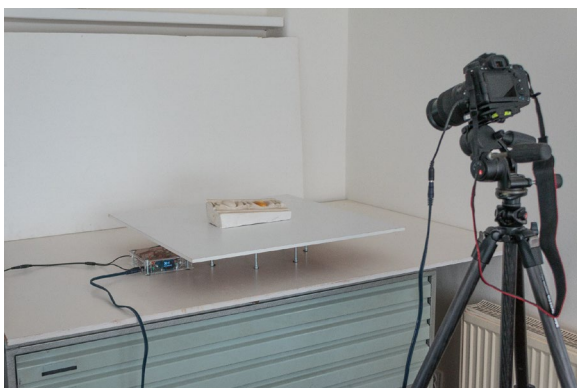
A) Snímkování odlitku pomocí fotoaparátu a 3D točny.
