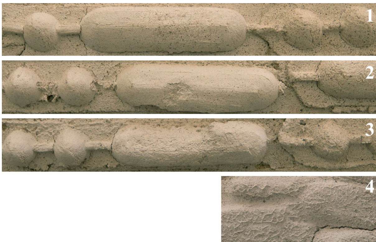
Obr. 56 Vliv vlhkosti štuky na schopnost otisku přenést a udržet tvar formy, 1) w = 0,8 ; 2) w = 0,83 ; 3) w = 0,85 ; 4) w = 0,9 133
