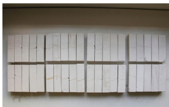
Obr. 2: Sádrové vzorky slepené zkoumanými organickými adhezivy, které byly podrobeny zkouškám.
