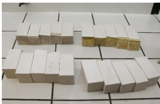
Obr. 1: Rozlomené vzorky opatřené separačním roztokem připravené na slepení.
