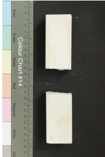
Obr. 4: Rozlomení sádrového vzorku v lepeném spoji.
