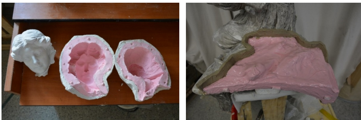
Obr. 10: Doplňky vymodelované v sochařské hlině jsou otištěny do silikonové formy, z které jsou následně vytvořeny sádrové odlitky.
