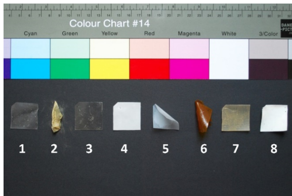
Obr. 6: Vzhled filmů adheziv před vystavením zátěžovým zkouškám.
