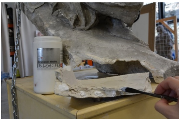
Obr. 14: Pokud je doplněk prvkem stability odlitku, je vždy nezbytné zvláště bodově lepený spoj podpořit ještě dalším zajišťujícím prvkem.
