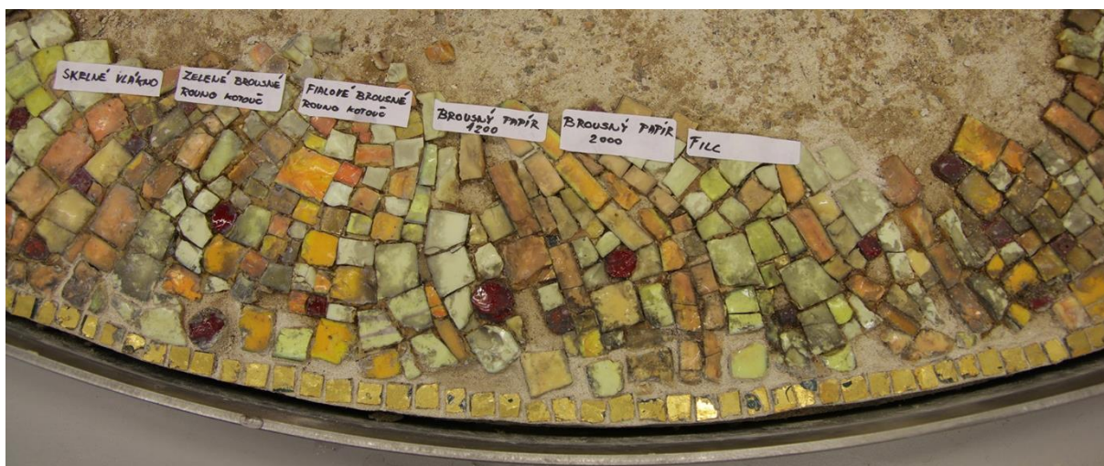
Obr. 32: Zkoušky čištění tmavého povlaku na mozaice Žena – květ z Rooseveltovy ul. v Chomutově – zkoušky mechanického a abrazivního čištění pomocí mikrobrusky, na které byly upevněny následující abrazivní materiály: sklené vlákno, středně hrubé brusné round, jemné brusné round, brusný papír 1200, brusný papír 2000 a filc.
