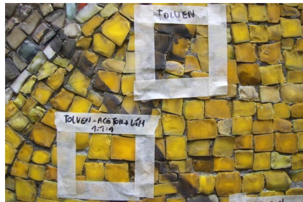
Obr. 27: Zkoušky čištění mozaiky v Praze-Vršovicích. Zkouška čištění pomocí toluenu a rozpouštědlové směsi obsahující toluen, aceton a technický lih v poměru 1 : 1 : 1 (obj.).
