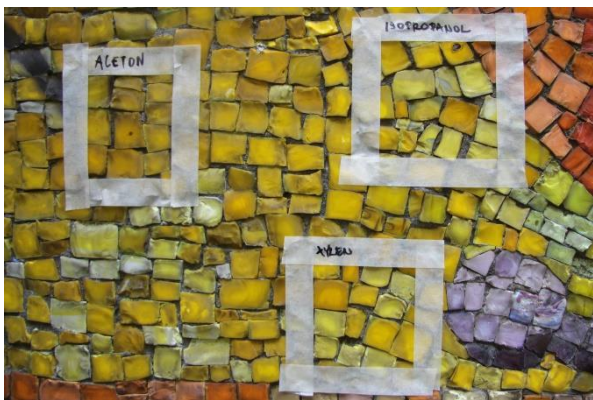
Obr. 26: Zkoušky čištění mozaiky v Praze-Vršovicích. Zkouška čištění pomocí acetonu, xylenu a isopropanolu.
