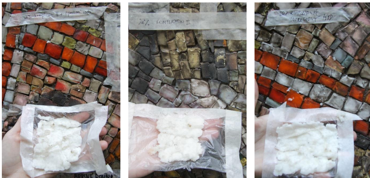
Obr. 31: Zkoušky čištění mozaiky v Praze-Vršovicích. Zkoušky čištění pomocí chelatačních činidel: Komplexon II (kyselina ethylendiamintetraoctová, EDTA) upravený čpavkovou vodou na pH 7 (nasyčený roztok), Komplexon III (disodná sůl kyseliny ethylendiamintetraoctové) upravený hydroxidem sodným na pH 7 (nasyčený roztok) a komplexonát tetrasodný hydrát (tetrasodná sůl kyseliny ethylendiamintetraoctové) – 20% (hm.) roztok. Testované roztoky byly aplikovány v zábalu z papíroviny Arboceľ BC 200 na 90 minut.
