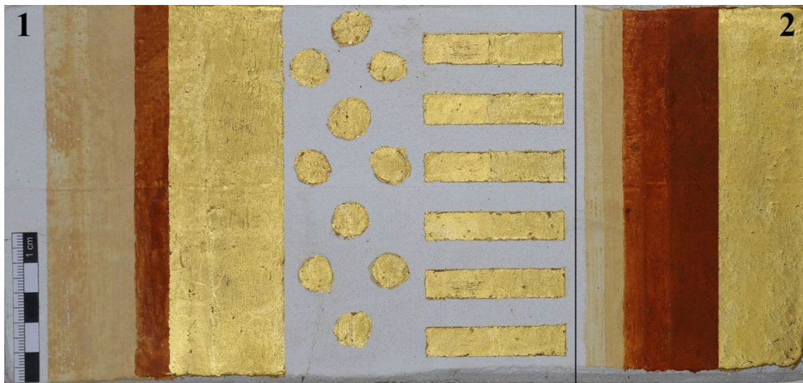
Obr. 26: Provedení technologické kopie ke zlacení kaple Věch svatých, SZ Telč – REPLIKA 1 (levá část snímku) a 2 (vpravo). Foto a grafická úprava: Radka Zůfalá.
