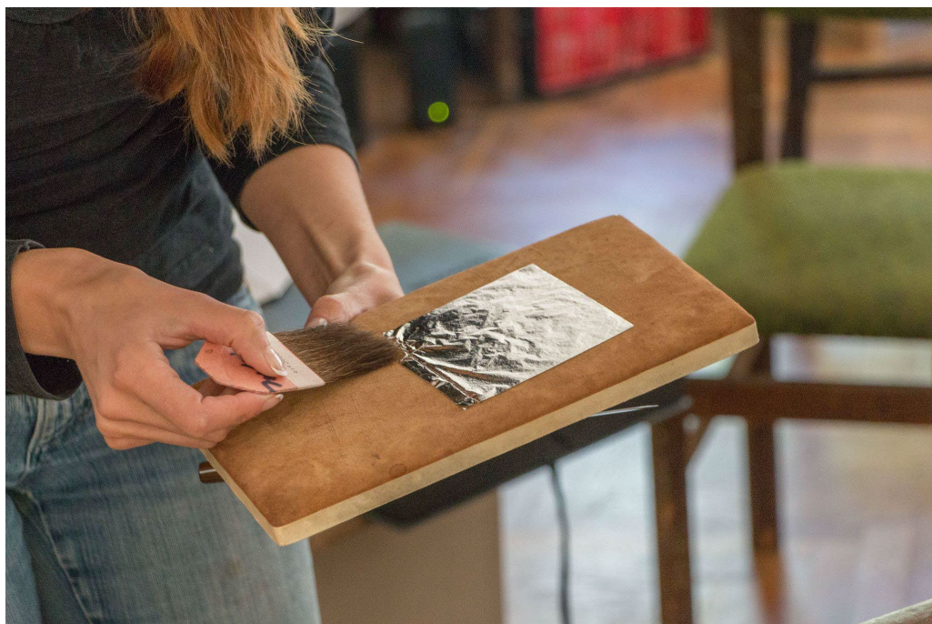
Obr. 7: Plátek zlata vyjmutý z knížky a přenesený na polštářek. Pro přenesení se používá pokládací štětec. Foto: V. Krajíček.
