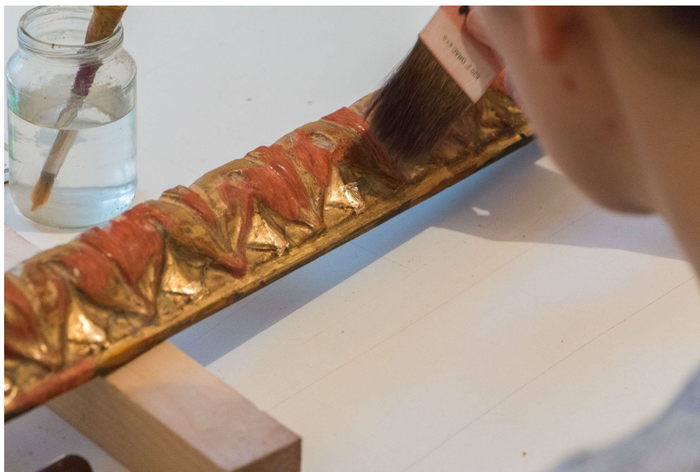
Obr. 16: Zlacení dřevěných ráků na poliment. Ilustrativní fotografie. Foto: V. Krajíček.
