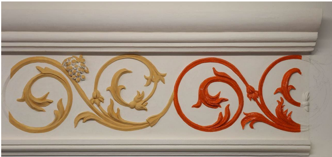
Obr. 34: Okrová podmalba mordantového zlacení dle kaple Všech svatých (vlevo) a první vrstva mixtionu u repliky zlacení na mixtion podle kaple sv. Jiří (vpravo). Foto: R. Zůfalá.
