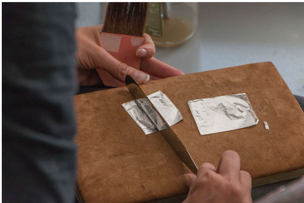
Obr. 8: Krájení plátku zlata pozlacovačským nožem. Foto: V. Krajíček.
