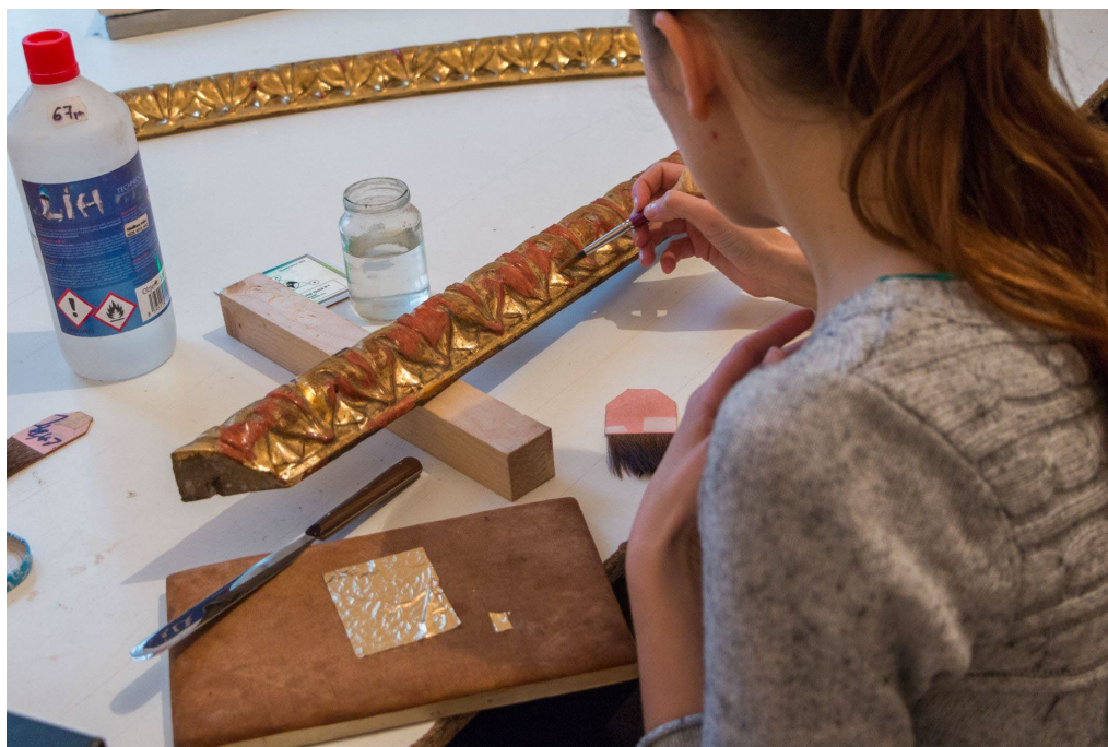
Obr. 9: Pokládání zlata tzv. „na kořalku“ pomocí aktivace bolusového podkladu lihem. Foto: V. Krajíček.
