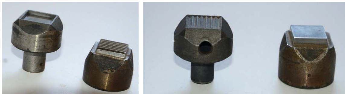
Obr. 15 Dva typy kaplíků na výrobu replik sintrované mozaiky lišící se polohou broku. Foto I. Kučerová
