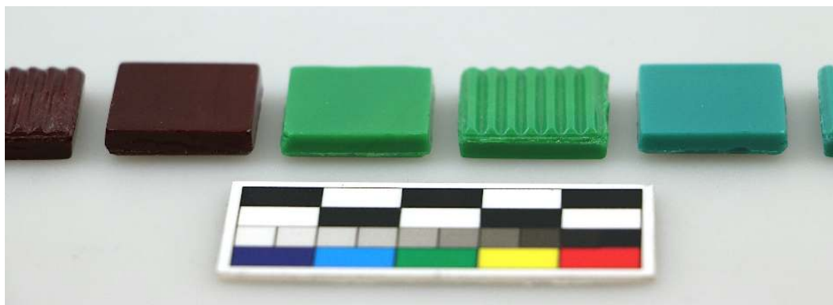
Obr. 20b Repliky sintrované mozaiky, na rozdíl od originálních sintrovaných kostek je patrný cca v prostředku tloušťky kostky tzv. brok. Foto I. Kučerová
