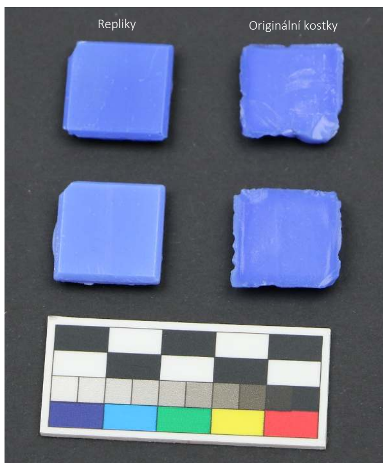
Obr. 19b Porovnání barevnosti repliky hladké lité mozaiky (kostky vlevo) s originálními kostkami (vpravo). Foto I. Kučerová
