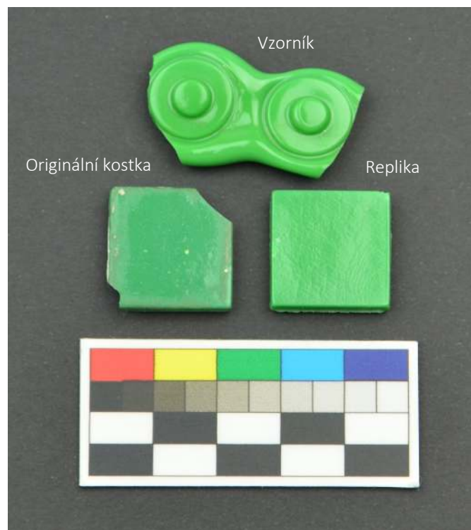
Porovnání originální kostky (Vlevo) s vyrobenou replikou (vpravo) a vymáčkaným tvarem vzorníku tyčového skla. Foto I. Kučerová
