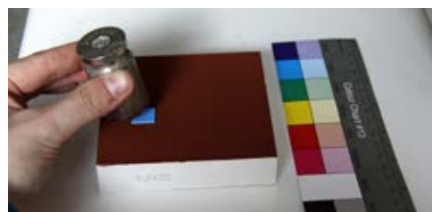
Obr. 6 Metoda měření adheze a koheze barevné vrstvy Tape testem za pomoci odtrhové pásky. Foto: Petra Zítková
