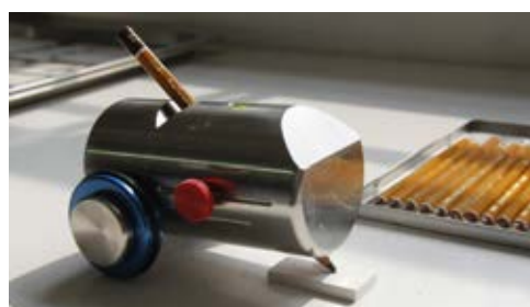
Obr. 4 Metoda měření tvrdosti povrchu – Wolff Wilborn tužkový test. Foto: Petra Zítková
