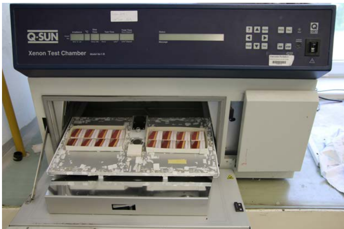
Obr. 3 Umístění dvou sérií vzorků v komoře pro umělé stárnutí Q-Sun Xenon Test Chamber. Foto: Barbora Vařejková.
