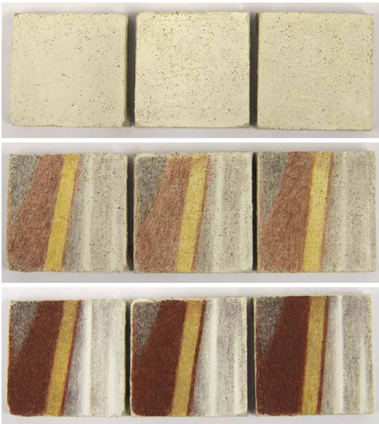
Obr. 2 Ukázka aplikace retuší. První řada: tělíska před retuší; druhá řada: mezistav /intenzita akvarelové retuše u kombinovaných technik; třetí řada: výsledný stav. Foto: Barbora Vařejková.
