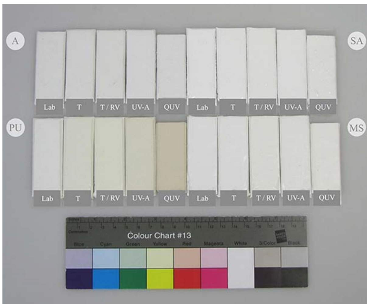
Obr. 2 Porovnání vzorků tmelů po expozici 30 dnům přirozeného stárnutí v laboratoři a umělého stárnutí za různých podmínek. Foto: Martina Nováková
