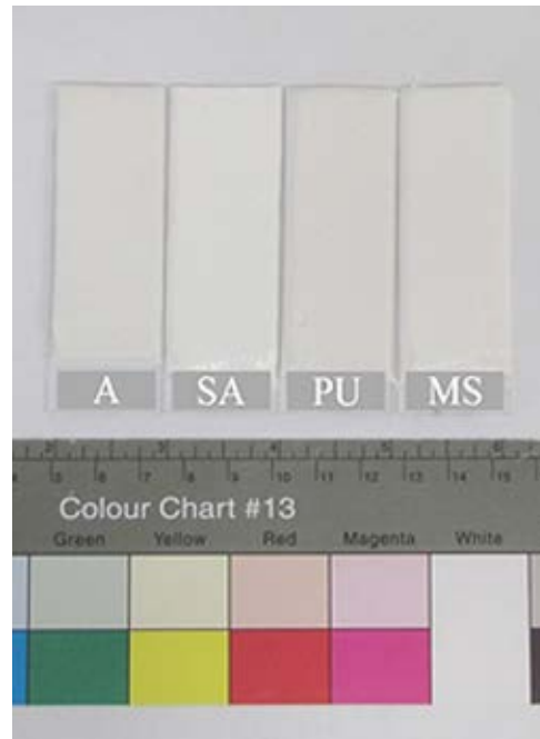
Obr. 1 Sesítované vzorky tmelů nanesené na podložních sklíčkách. Foto: Martina Nováková
