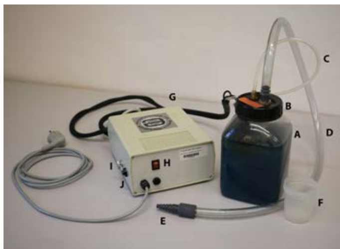
Obr. 2 Ultrazvukový minizmlžovač, výrobce Günther Engelbrecht GmbH: A. čtyřhranná láhev, B. šroubovací uzávěr, C. transportní hadička na vzduch, D. pracovní hadice, E. výstupní měnitelná tryska, F. zásobní nádobka, G. regulační zařízení (síťový adaptér), H. kolébkový spínač, I. tlumicí šroub s rýhovanou hlavou, J. spínač na přerušení výroby transportního vzduchu. Foto: Kateřina Beranová
