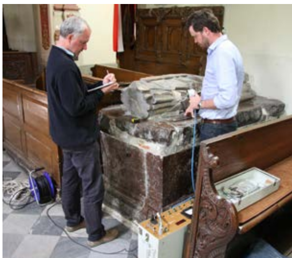
Obr. 2 Restaurátorský průzkum – měření ultrazvukové transmise. Foto: Univerzita Pardubice, Fakulta restaurování.
