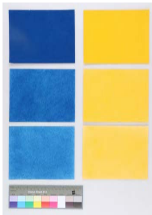
Obr. 1 Zkoušky nanášení pastelu na filtrační papír Whatman Grade No. 1: a) přímé nanášení, b) nanášení pomocí třerky, c) nanášení pomocí vatového smotku; pastel žlutý okr a pruská modř. Foto: Kateřina Beranová
