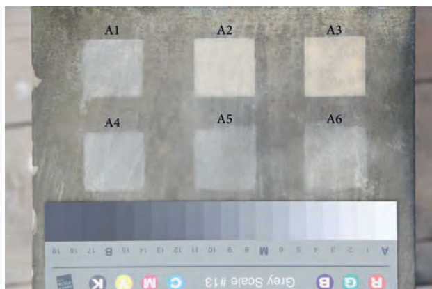
Obr. 6 Čištění mikropískováním, vzorek A1–A6. (Foto J. Ďoubal, 2012)
