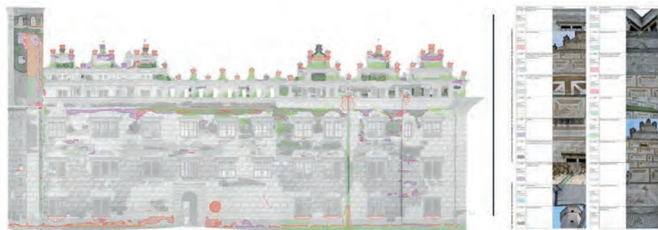
Obr. 11 (dole) Vnější plášť zámku, severní fasáda – poruchy. (Fotoplány K. Pavelka, zářezky E. Racková, J. Vojtěchovský, třídění K. Krhánková, J. Vojtěchovský, 2011)
