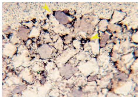
Obr. 1. Petrologie, Pískovec křemenný, jemnozrnný, silicifikovaný – polarizační mikroskop, zvětšení 32x, nikoly X struktura převažujících srůstajících křemenných úlomků (silicifikace), slídko–muskovit, (foto Z. Štaffen, 2012)
