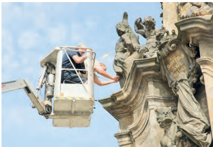
Obr. 5 Polička, mariánský sloup, měření metodou ultrazvukové transmise, na snímku v koši vysokozdvížečné plošiny K. Bayer, P. Gläser. (Foto Z. Gläserová Lebedová, 2012)
