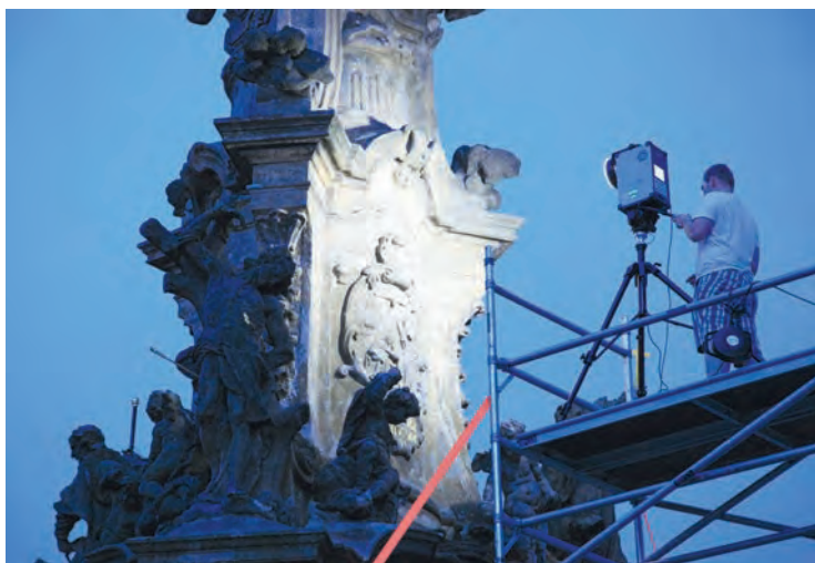
Obr. 6 Polička, mariánský sloup, laserové skenování vybraného mariánského reliéfu, na snímku Z. Marek. (Foto P. Gláser, 2012)
