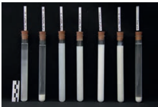
Laboratorní testování sedimentace nano-suspenzí hydroxidu vápenatého.
