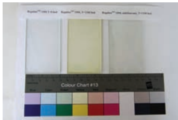
Film pryskyřice Regalrez ® 1094 na skleněné podložce. Standard (vlevo), po stárnutí (uprostřed), s přidavkem stabilizátorů (vpravo).
