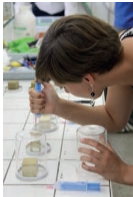
Testování penetrace laboratorních vzorků vápennými nano-suspenzemi.
