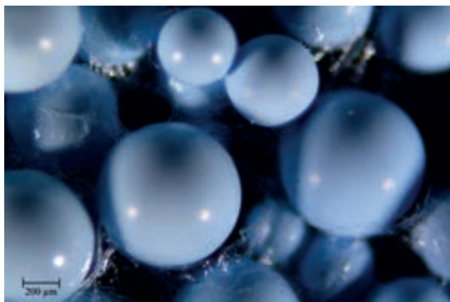
Změna zbarvení iontoměniče po aplikaci na vzorek barevné vrstvy pigmentované měděnkou (optický mikroskop, dopadající světlo).
