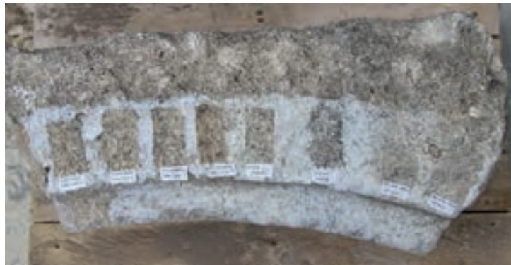
Zkoušky odstranění bílých zákalů provedených po aplikaci konsolidantu CaLoSiL® E25 na sochu anděla. Zleva: 4 zkoušky suchého abrazivního čištění; 2 zkoušky mokrého čištění; 2 zkoušky chemického čištění – buničinné obklady s roztokem kyseliny citronové.
