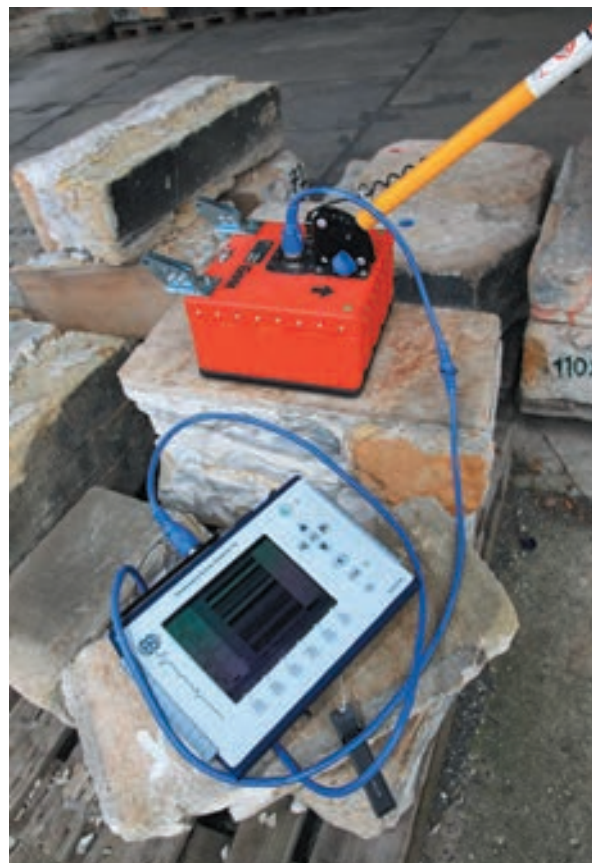
Obr. 10: Měření pozemním penetrujícím radarem SIR – 3000 s anténou 400MHz (foto P. Glaser)
