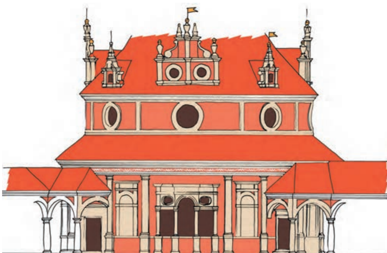
Obr. 8: První návrh barevného řešení Rondelu bez detailního řešení římsy a kanelur na pilastrech v přízemí, s později změněnou podobou soklové části
