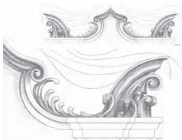
Obr. 13: Mikulov, synagoga, Výrobní dokumentace – Ing. arch. Matěj Barla a kol., kresby MgA. Jiří Kobr – detail římse 3 – volutový tympanon, 2013
