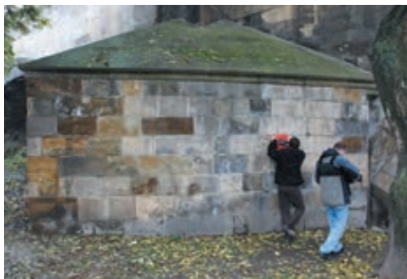
Obr. 8: Karlův most v Praze, měření pozemním penetrujícím radarem SIR – 3000 s anténou 400MHz (foto P. Glaser)
