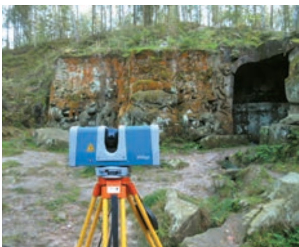
Obr. 15: Reliéf Klanění králů z Betléma v Novém lese u Kuksu, dokumentace 3D laserovým skenerem, Handy Scan (foto M. Dvořák)
