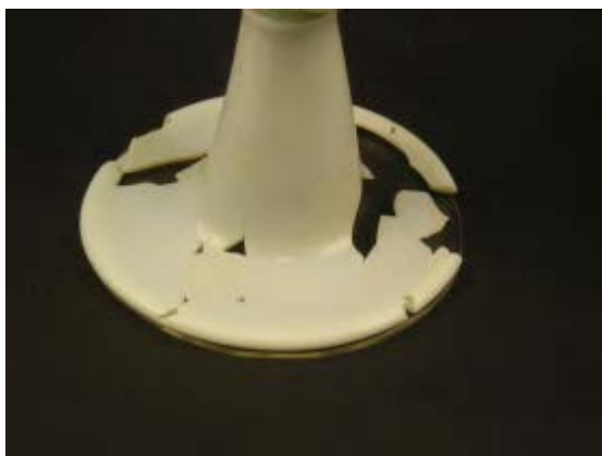
Obr. 10 Detail vyčištěné nohy a nově vytvořené PMMA opory.
