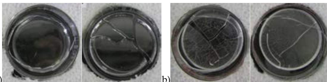
Obrázek 8 – Fotografie gelů po 28 dnech od nalití směsi tvořené při 53 % relativní vlhkosti a) gely katalyzované DBCDA b) gely katalyzované DBCDL.
