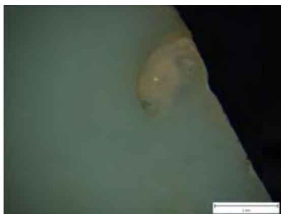
Obr. 8 Neprotavená částice ve hmotě skla.
