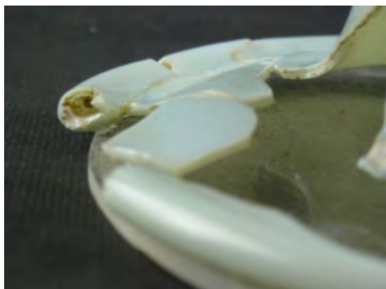
Obr. 5 Snímek dokumentující nečistoty v okraji patky/nohy.
