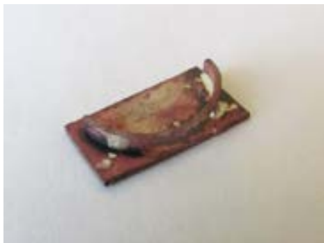
Obr. 27: přiletování boční části na plech
