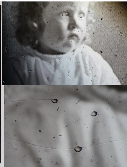
Průzkum diapositivů na skle před restaurováním – skelná koroze (výše), plíseň (níže)
