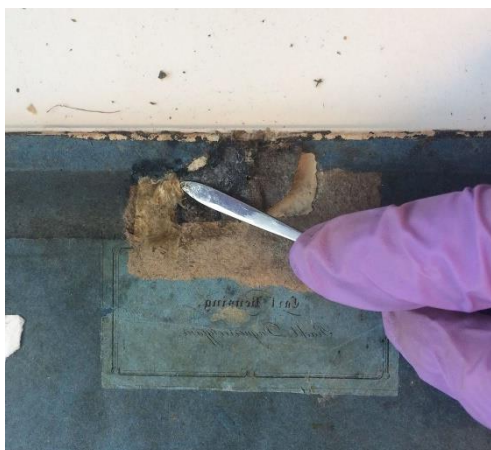
Daguerreotyp z r. 1853 – restaurování (před, po, průběh odkrývání a restaurování závěrného systému)
