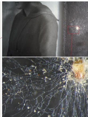
Průzkum diapositivů na skle před restaurováním – skelná koroze (výše), plíseň (níže)
