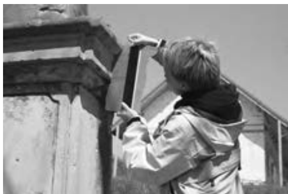
Oměřování profilace římsy Kalvárie v Bukvíci tzv. „břebeňem“
